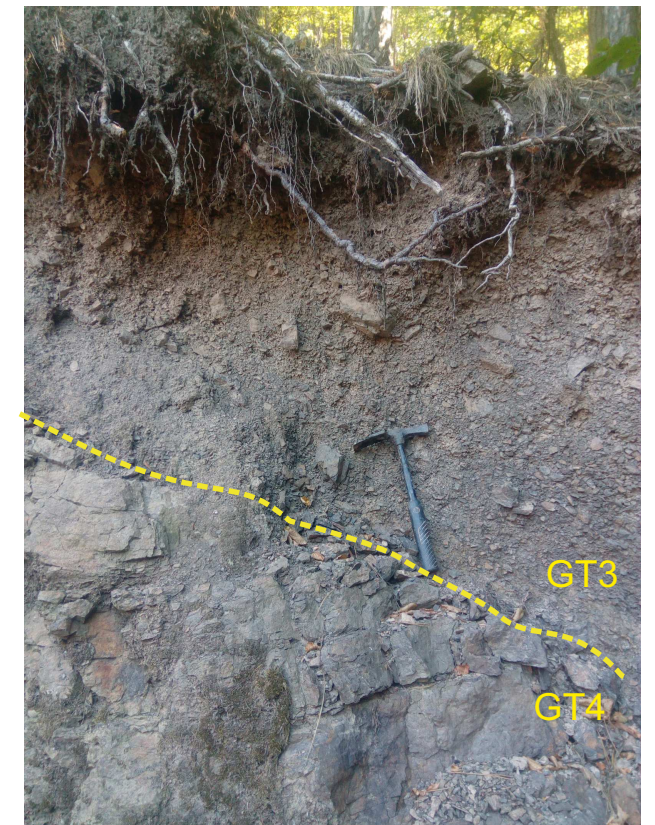
Ukázka přechodu svahovin GT3 do horninového podloží ve výchozu za domem V Chaloupkách 81.
